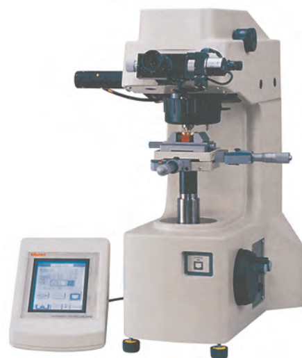
HM-112 Цифровой дисплей и функция статистического расчета
