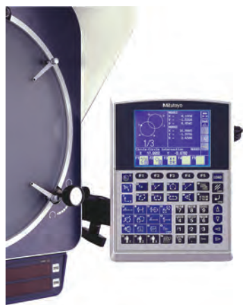
Монтаж на кронштейне
