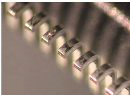
Пример измерения : высота пиков на QFP-корпусе
