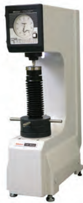
HR-210MR Машина для измерения твердости по Роквеллу Ручное изменение веса (с выбором общего испытательного усилия) и управление преднагрузочным усилием. Моторный привод контролирует последовательность нагрузки.
