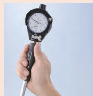
Новый держатель улучшает точность при длительном использовании
