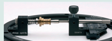
Крепление цилиндрических деталей.
