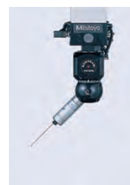
MPP-10 Для эффективного измерения глубины резьбы
