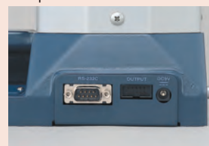
Порт вывода данных (стандартный) Digimatic и RS-232C
