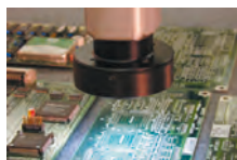
QVP (быстродействующий видеодатчик) Для видео-измерений Программное обеспечение: VISIONPAK
